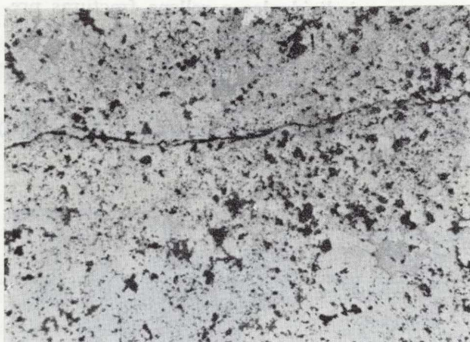
Figura 2.—Aspecto de la textura. Pirita carbonatada con calcopirita. Pirita: color blanco; calcopirita: color gris; carbonatos: color negro. Microscopía óptica de reflexión, n. p. ( \times 70 ).
